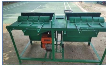
PETOKONG *Double block cutter* Tampak Depan    PETOKONG *Double block cutter* Tampak belakang
