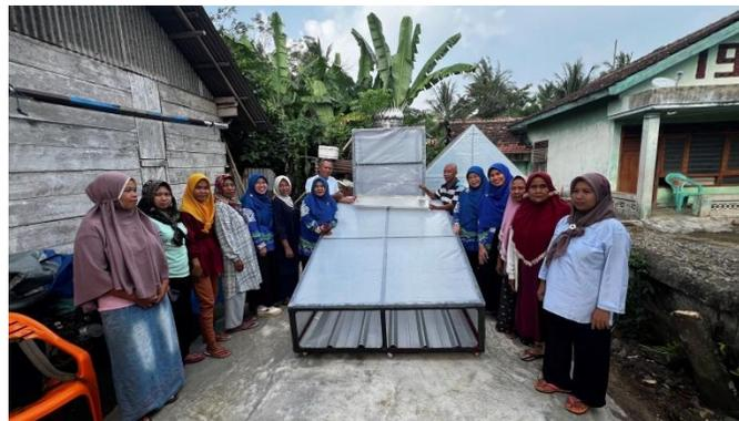
**Gambar 2.** Pengering terasi *portable*
